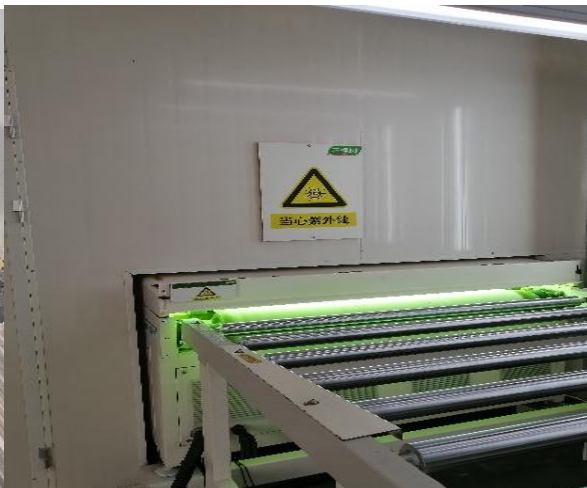
UV固化机进出口处无警示标识（整改后）
