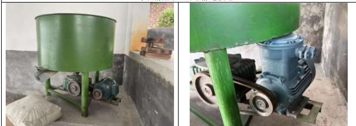
湿药混合已使用防爆电机
